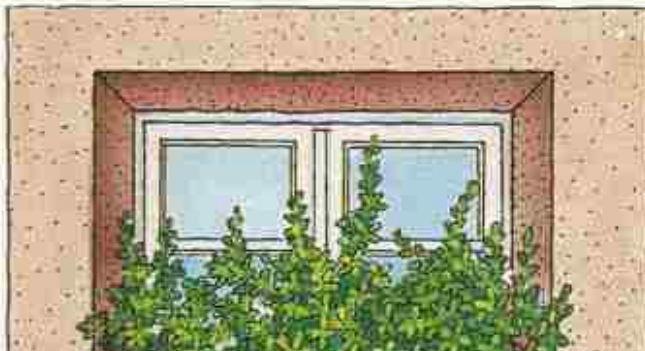
Der Wasserdampf von Atem, Kochen, Waschen, Duschen schlägt sich am Glas von dichten Fenstern nieder.
